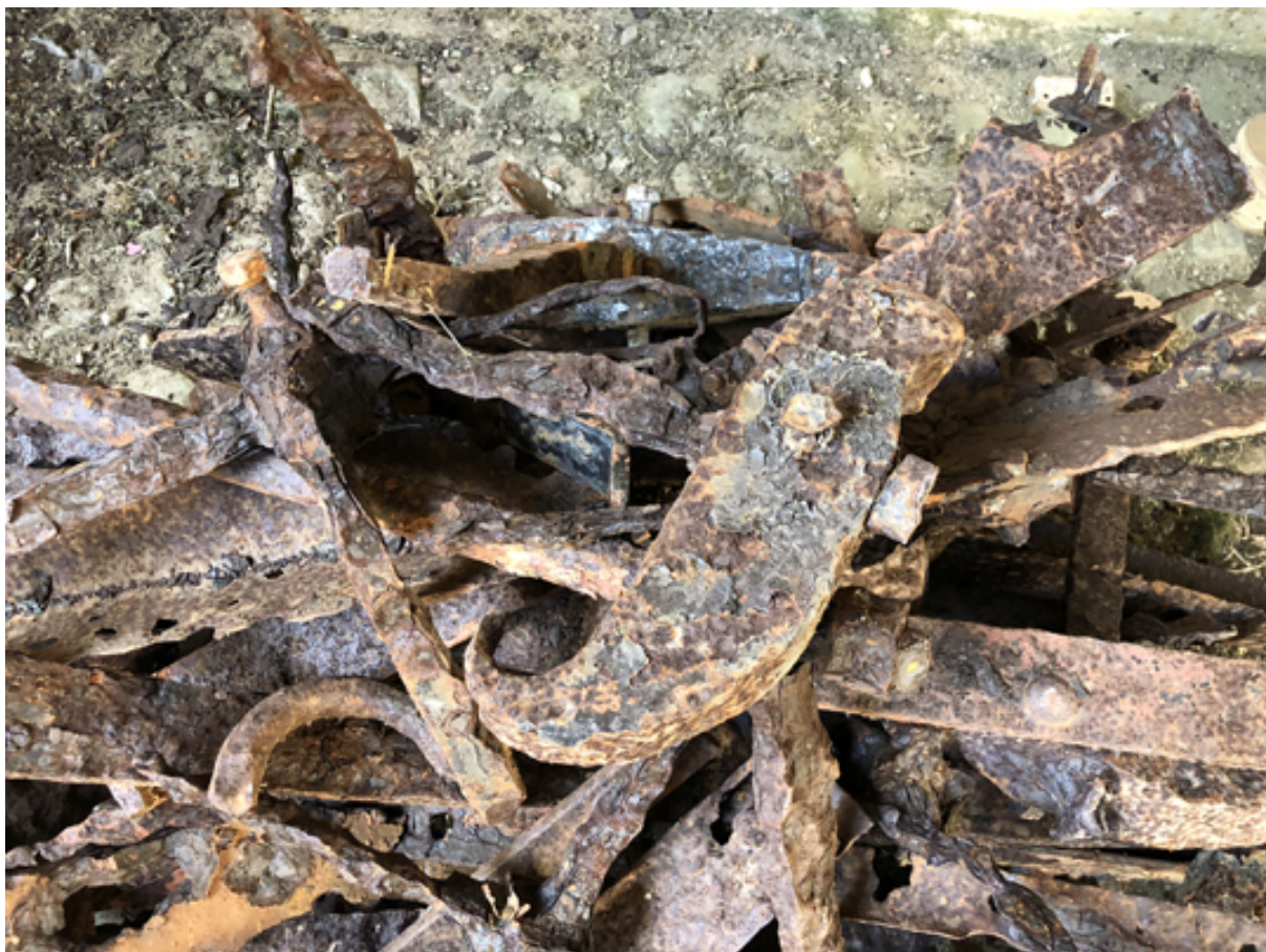
boven: door roest aangetaste hamers voor het automatisch spel
